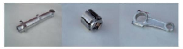
Lavorazioni di tornitura e fresatura a 5 assi
